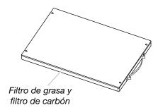
Filtros de carbón: Los filtros de carbón están en la cara inferior del horno microondas. El filtro de carbón no se puede limpiar y deberá reemplazarse cada 6 meses.
